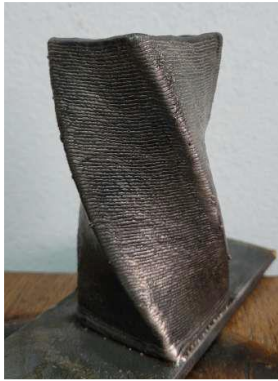
Figura 1. Componente impreso por WAAM en acero inoxidable 316LSi.
