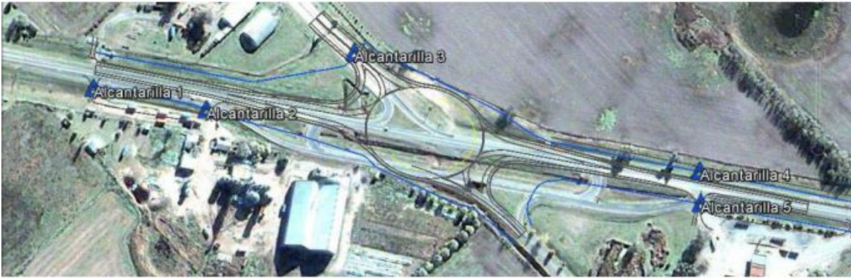
Figura 7. Ubicación de alcantarillas en intersección rotacional
