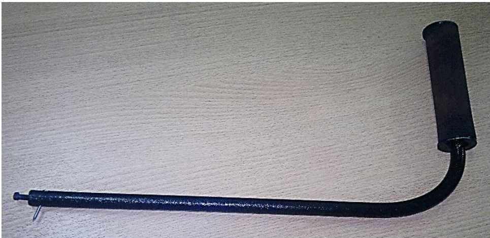
Figura 3- Trazador para determinar la desviación de la fibra
