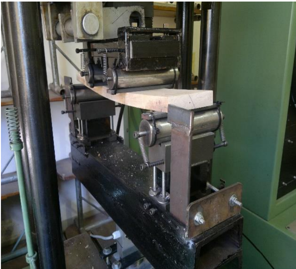
Figura 5.- Ensayo de una tabla a flexión en la máquina Baldwin
