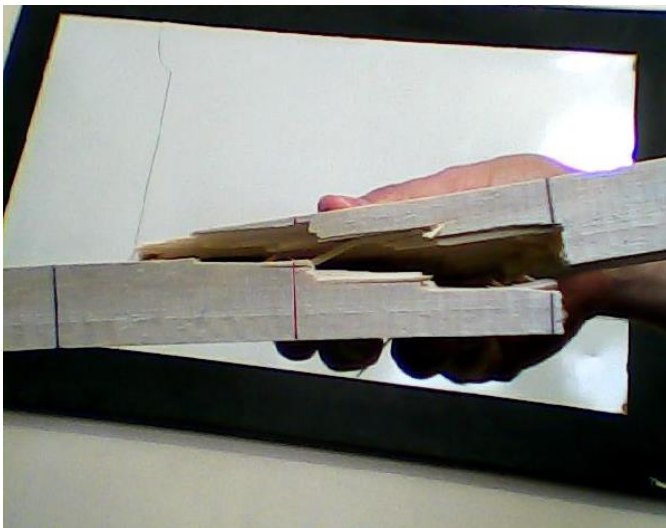
Figura 7.- Fotografía de la rotura de la probeta en una de sus caras
