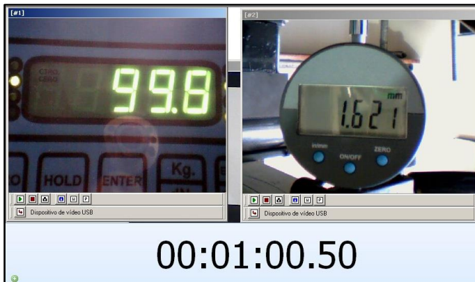
Figura 6.- Captura simultánea de carga, deformación y tiempo
