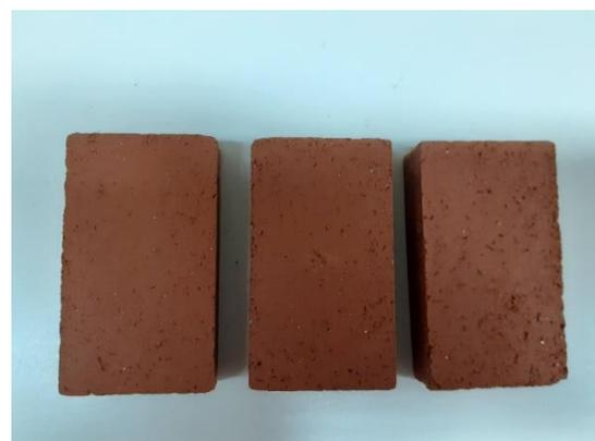
Figura 2. Ladrillos con 5, 10 y 15% de cáscaras de girasol adicionada.
