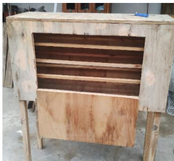
Vista interna de la cámara de secado con sostenes internos para portar las bandejas con los alimentos.
